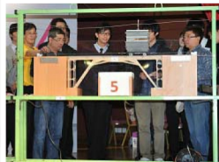
香港聖公會何明華會督中學學生製作的橋樑，成功讓負重達66公斤的小車通過。
